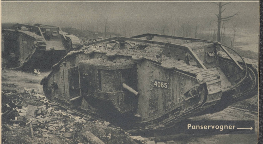
Den engelske tank fra 1915. På dette monstrum er det bare larvekedene som er vellykket, den lange skyttergravsaks som skulde skjære gjennom piggråden, viste seg meget snart å være uhensiktsmessig. Dertil kom at kjøreren satt
