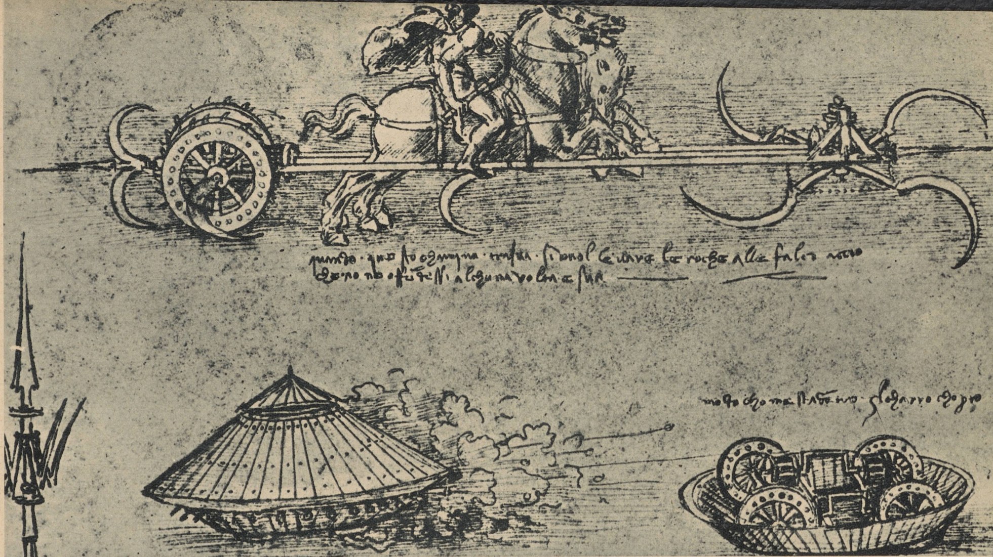
Konstruksjon av panservogner for 400 år siden: Angående denne tegning skrev Leonardo da Vinci til sin venn, grev Sforza: „Jeg bygger sikre og beskyttede vogner som er uangripelige; når de går like mot fienden med sine kanoner må selv motstanderens sterkeste masser vike tilbake, og bak disse vogner kan infanteriet rykke fram i sikkerhet uten å bli hindret.“ Den engelske generalmajor I. F. C. Fuller sa 400 år seinere at „Leonardo hadde en klarere forestilling om et tankangrep enn mangen britisk soldat før slaget ved Cambrai. 14 måneder etter at tanks var tatt i bruk på slagmarken“. Så betydelig enn Leonardos taktiske innsikt var, så hadde hans panservogner dog en prinsipiell feil, de var nemlig ikke brukelige i kupert terreng, men bare på flat mark
