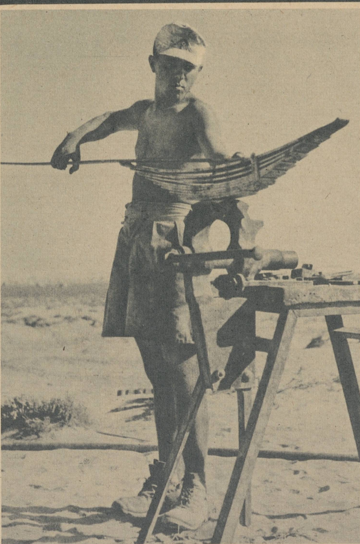
Brudd på bilfjærene hører til dagens orden i dette steinete ørken-terrenget. Fjærsmia har imidlertid et særlig stort lager av reservedeler, hvilket gjør det mulig for den å utføre enhver reparasjon hurtig
