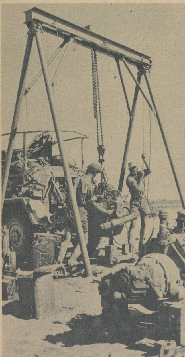
Ørkenverkstedets folk er allsidige karer. Her løfter de motoren ut av en panserrekognoseringsvogn. Den skal ha en grundig overhaling. De er fullt fortrolig med alle motortyper
