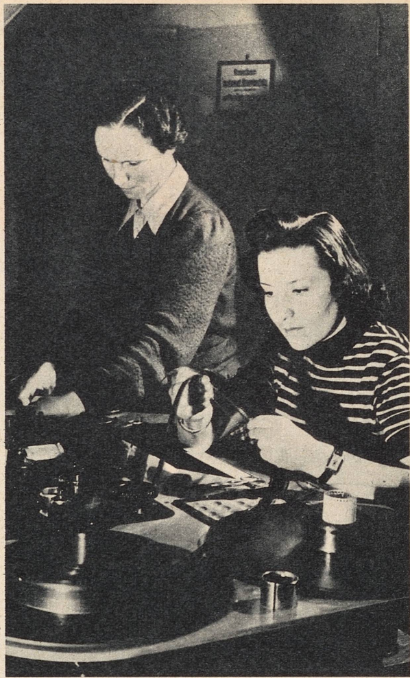
8 Av de enkelte handlingskomplekseres lydband og filmstrimler blir originalen til den nye ukerevy klebet sammen og tar så vegen til kopieringsanstaltene
