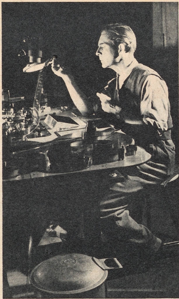
7 Til bildet kommer lyden: speakerens tekst, originalstøyen og en passende musikk blandes sammen ved en blandingspult og blir ført over på et felles lydband
