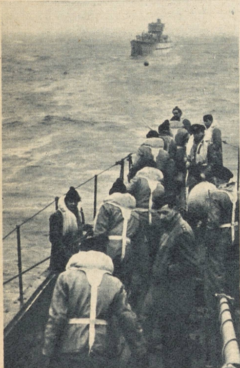
Klar zur Ölübernahme. Das Kampfboot hat den Ölschlauch aufgefischt und am Einfüllstutzen seines Brennstoff-Bunkers angebracht
