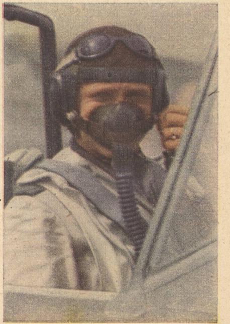
Kopfhülle mit eingebauter Hörmuschel und Sauerstoffmaske vervollständigen die Ausrüstung. Bei Luftkämpfen, die heute in 7000 und mehr Metern Höhe ausgetragen werden, ist die Sauerstoffmaske unentbehrlich
