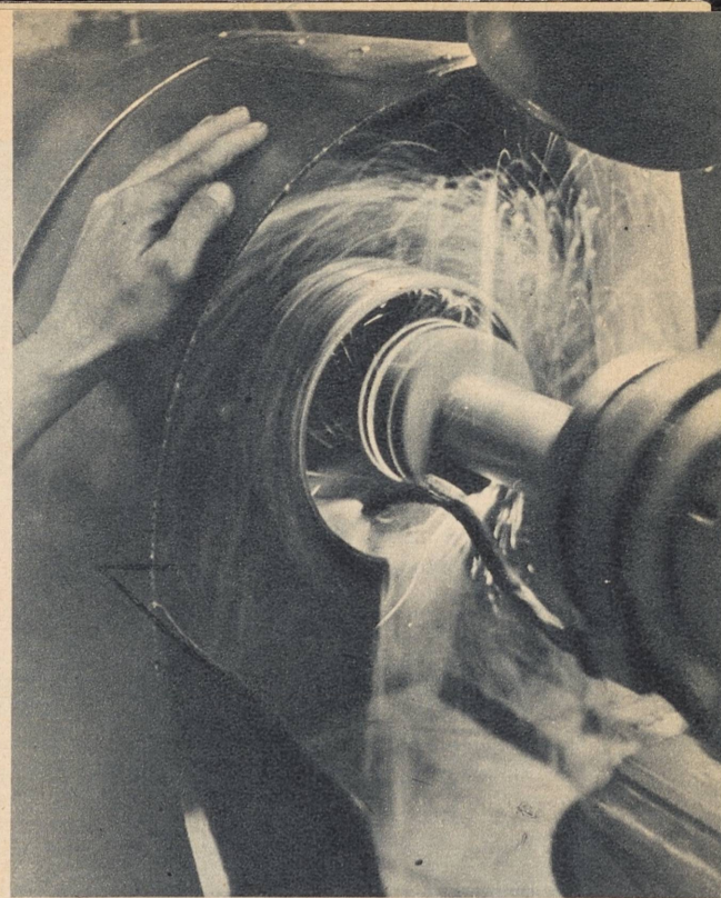
Presisjonsarbeid. Karborundum-skivene i slitemaskinen gir stålet i kulelagerskålene den siste jevnhet og det nøyaktige mål. Uhindret blir det arbeidet i dag- og nattskift
